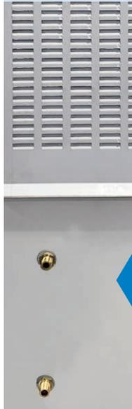
**Wassergekühlte Maschine.** Die Kühlung des Kühlsystems erfolgt über den ein- und ausgehenden Wasserkreislauf, der an der Rückseite der Maschine zugänglich ist.
